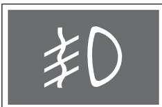
При включении задних или передних огней противотуманные фары тоже будут включены, если выключатель противотуманных фар установлен в положение «ON». При этом на комбинации приборов загорается индикатор активации противотуманных фар.
