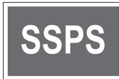
Данная контрольная лампа загорается при возникновении неисправности в системе SSPS. При активации данной контрольной лампы к рулевому колесу необходимо прикладывать большее усилие.
