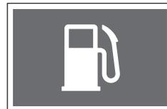
Данная контрольная лампа предупреждает о том, что запас топлива в баке на исходе. Оставшееся количество топлива позволяет продолжить движение еще в течение некоторого периода времени, продолжительность которого зависит от режима движения автомобиля и дорожных условий.
