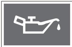
Данная контрольная лампа загорается при включении зажигания и должна погаснуть сразу после запуска двигателя.
