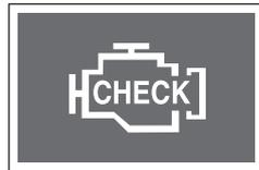
Если контрольная лампа продолжает гореть или загорается во время движения, значит, некоторые из компонентов системы управления двигателем, в том числе датчики и устройства, неисправны.
