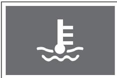
Когда температура охлаждающей жидкости превышает максимально допустимое значение, данная контрольная лампа начинает мигать, и звучит предупреждающий сигнал. В этом случае необходимо остановить автомобиль в безопасном месте и дать двигателю остыть. Более подробная информация приведена в главе 12 «Перегрев двигателя».
