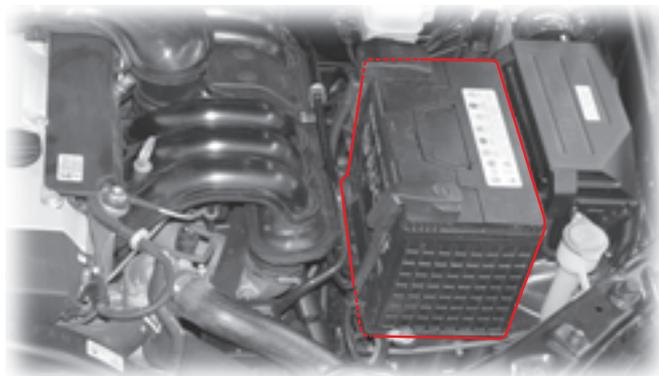
Если на комбинации приборов загорается контрольная лампа (☹️), это указывает на неисправность системы зарядки аккумуляторной батареи. Если контрольная лампа загорается во время движения автомобиля, выключите все дополнительные электрические устройства и обратитесь в салон дилера Ssangyong или в авторизованный сервисный центр Ssangyong для проверки системы.
