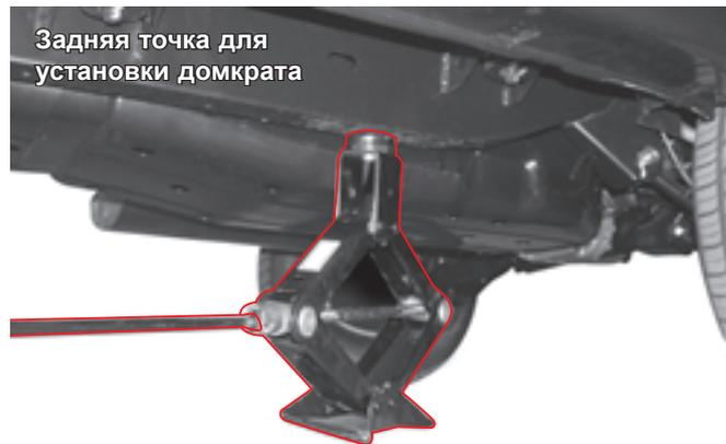
2. Установите домкрат так, чтобы его верхняя часть вошла в контакт с кузовом в специально предназначенной для этого точке.
