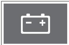
Данная контрольная лампа загорается при включении зажигания и гаснет после запуска двигателя.
