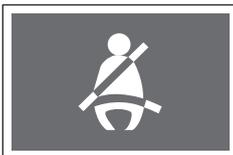
Данная контрольная лампа загорается, если ключ в замке зажигания находится в положении «ON», а ремень безопасности водителя не пристегнут, при этом в течение 6 секунд будет звучать предупреждающий звуковой сигнал.
