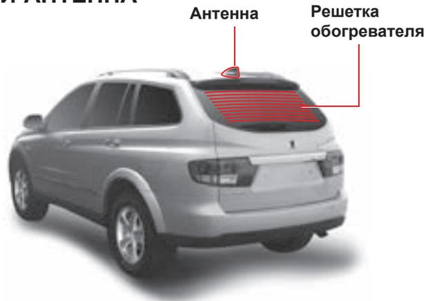
На стекло двери багажного отделения нанесена «решетка» (токоведущие дорожки) обогревателя заднего стекла. Будьте осторожны, чтобы не повредить дорожки при очистке внутренней поверхности стекла задней двери.
