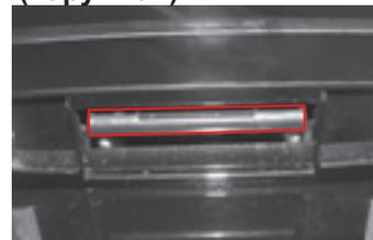
Для того, чтобы открыть дверь багажного отделения отпирите замок и отожмите рычаг ручки двери вверх.
