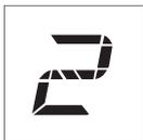
• Положение для движения, при котором не допускается переключение на третью или четвертую передачу. Режим движения на 2-й передаче следует выбирать, когда требуется большое усилие для движения на подъеме, а также для использования эффекта торможения двигателем при движении на затяжном спуске.
