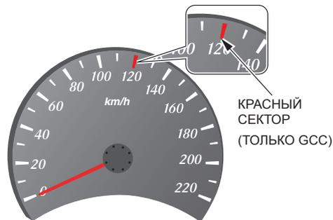
Спидометр показывает скорость движения автомобиля в километрах в час (км/ч) или милях в час (миль/ч).
