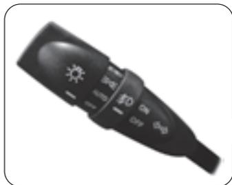
Данный переключатель предназначен для включения/выключения наружных световых приборов (фар, задних фонарей, габаритных огней, подсветки регистрационного номера, сигналов поворота, противотуманных фар).
