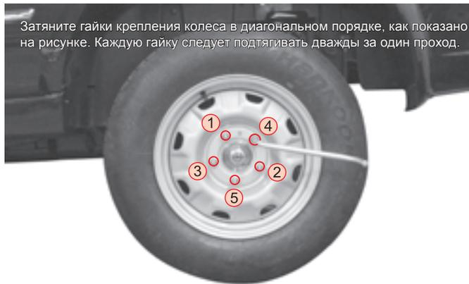
6. После этого установите запасное колесо и затяните гайки предварительным усилием, так чтобы колесо плотно, без люфта прилегло к ступице.
