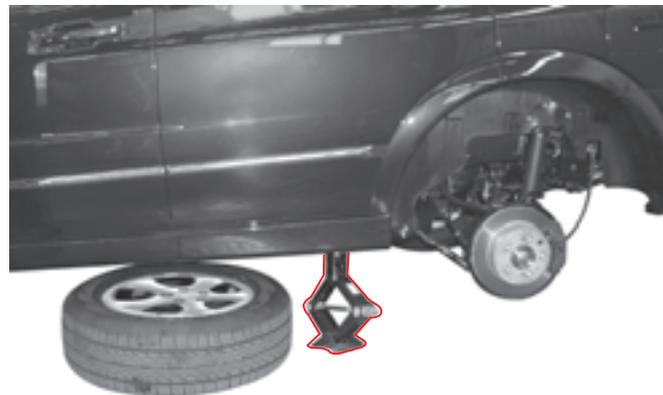
3. Соберите приспособление для домкрата и ключ для гаек крепления колеса, как показано на рисунке. Поднимите автомобиль при помощи домкрата, поворачивая ключ по часовой стрелке до тех пор, пока колесо не будет полностью вывешено.
