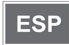
При нажатии выключателя «ESP<sub>OFF</sub>» система ESP отключается и на комбинации приборов загорается соответствующая контрольная лампа. Когда система ESP включается в работу, контрольная лампа начинает мигать.
