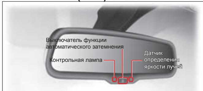
Отражающая способность салонного зеркала заднего вида может быть автоматически изменена в зависимости от яркости света фар приближающихся сзади транспортных средств, если нажать кнопку выключателя функции автоматического затемнения. При нажатии кнопки на зеркале загорается соответствующая контрольная лампа. При повторном нажатии кнопки функция отключается и контрольная лампа гаснет.
