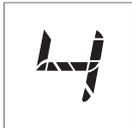
• Данный режим следует выбирать для движения в обычных условиях по дорогам с хорошим покрытием. В этом режиме происходит автоматическое переключение передач с 1-й по 4-ю в зависимости от скорости движения автомобиля.
