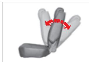
Для того, чтобы отрегулировать положение спинки, немного наклонитесь вперед и потяните рычаг (A) вверх. Затем обопритесь на спинку, найдите удобное положение и отпустите рычаг. После того, как регулировка была выполнена, убедитесь в том, что рычаг вернулся в исходное положение и спинка надежно зафиксировалась.
