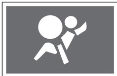
Данная контрольная лампа загорается при переводе ключа в замке зажигания в положение «ON» и гаснет после запуска двигателя.
