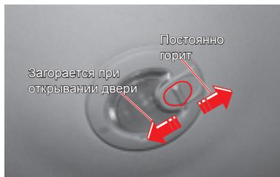
При перемещение данного переключателя по направлению к задней части автомобиля, светильник загорается. При перемещении переключателя в противоположном направлении, светильник отключается. Но он будет загораться при открытии какой-либо из боковых дверей. (Светильник будет работать в синхронном с дверьми режиме только если кнопка главного выключателя переднего светильника находится в нажатом положении.) При закрывании дверей светильник погаснет.
