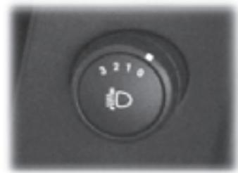
Включите ближний свет и отрегулируйте направление оптических осей фар в зависимости от загрузки автомобиля.
