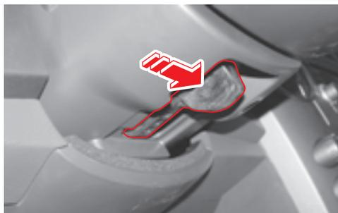
Для регулировки положения рулевого колеса отожмите рычаг фиксатора вправо; перемещая рулевое колесо вверх-вниз, установите его в требуемое положение; отпустите рычаг фиксатора и убедитесь, что рулевое колесо надежно закреплено.
