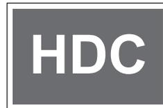
При первом нажатии кнопки выключателя система HDC переключается в режим готовности. На комбинации приборов контрольная лампа системы HDC загорается зеленым светом. При повторном нажатии кнопки система HDC отключается и контрольная лампа гаснет.
