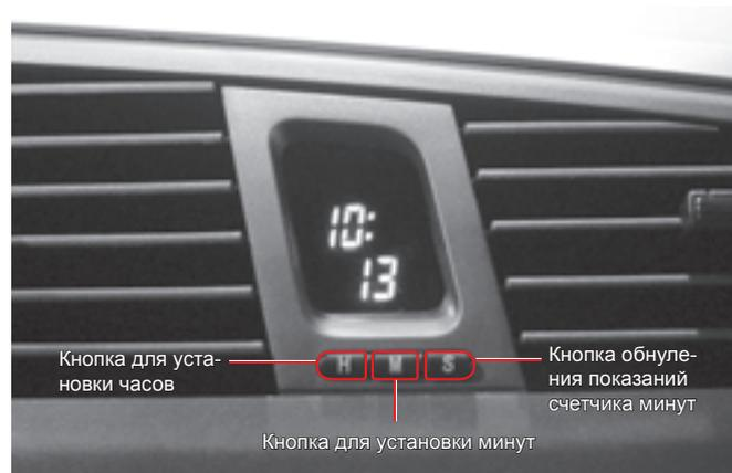
**H** (ЧАСЫ): Кнопка для установки часов
