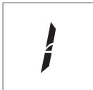
• В этом положении в коробке может быть включена только первая передача. Используйте данный режим для движения по пересеченной местности, горным дорогам и на крутых подъемах. Данный режим также обеспечивает возможность использования эффекта торможения двигателем.
