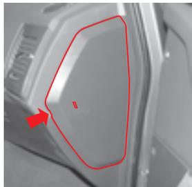
Блок предохранителей расположен с правой стороны панели приборов. Чтобы получить доступ к блоку предохранителей, необходимо открыть переднюю пассажирскую дверь, поддеть при помощи отвертки и снять крышку блока предохранителей.
