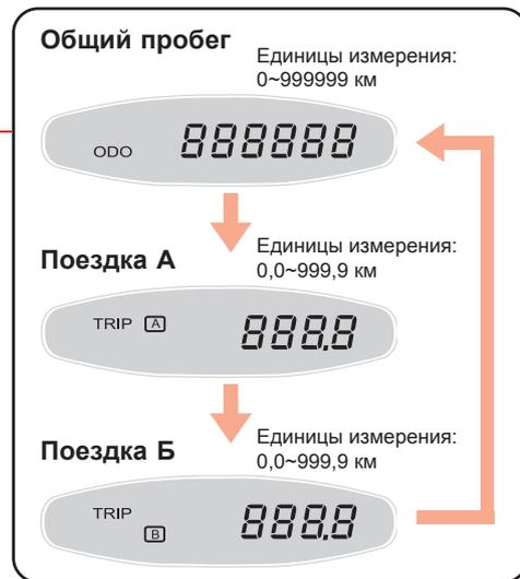
\* Если на комбинации приборов установлен спидометр со шкалой измерения в милях, показания пробега на дисплее будут указаны в милях.
