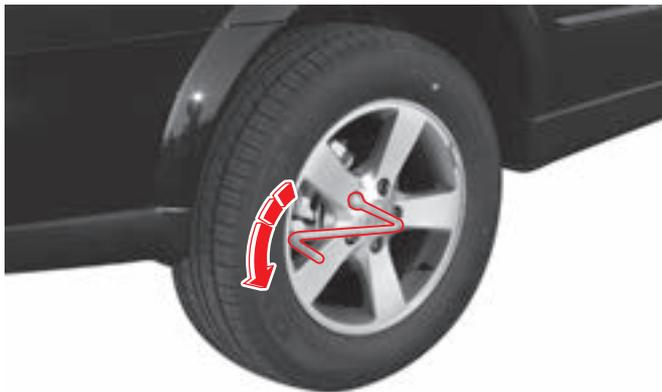
1. Отверните гайки крепления колеса на один или два оборота, поворачивая их против часовой стрелки при помощи специального ключа.
