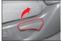
Для того, чтобы отрегулировать положение спинки, немного наклонитесь вперед и потяните рычаг вверх. Затем обопритесь на спинку, найдите удобное положение и отпустите рычаг. После того, как регулировка выполнена, убедитесь в том, что рычаг вернулся в исходное положение и спинка надежно зафиксировалась.
