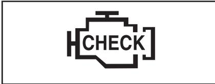
Контрольная лампа «Проверь двигатель» загорается при нарушении функционирования топливной или других систем с электронным управлением. В результате мощность двигателя может уменьшиться, или произойдет остановка двигателя. Обратитесь за помощью в ближайший сервисный центр дилера Ssangyong.
