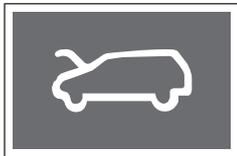
Данная контрольная лампа загорается, если капот двигателя открыт или закрыт не полностью.
