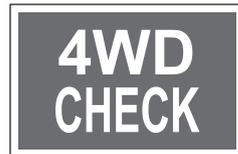
Данная контрольная лампа загорается при переводе ключа в замке зажигания в положение «ON» и должна погаснуть, если система исправна. Если контрольная лампа «4WD CHECK» не гаснет, проверьте систему в салоне дилера Ssangyong или в авторизованном сервисном центре Ssangyong.
