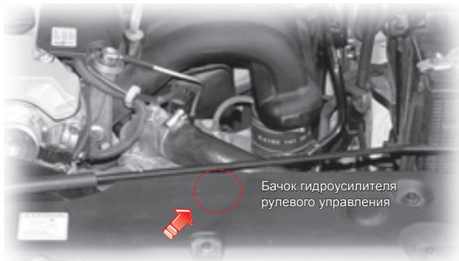
Бачок гидроусилителя рулевого управления
