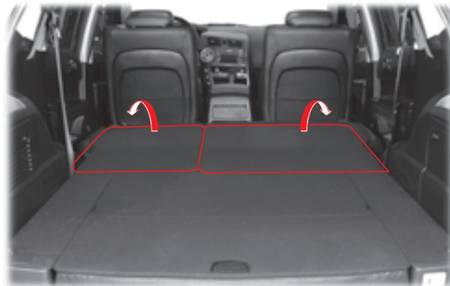
2. Для получения багажного отделения с плоским полом откидывайте спинки сидений вперед до тех пор, пока не раздастся щелчок фиксатора. Убедитесь в том, что спинки зафиксированы надежно.
