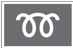
Данная контрольная лампа загорается при переводе ключа в замке зажигания в положение «ON» и остается включенной в течение короткого промежутка времени, либо сразу гаснет. Когда свечи накаливания достаточно разогрелись, лампа гаснет. На автомобиле, оборудованном
