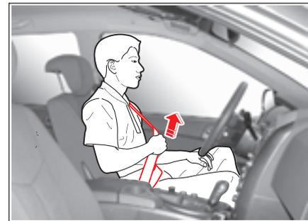
1. Вытяните ремень безопасности из возвратного механизма (натяжителя), удерживая ремень за металлическую скобу. Если при вытягивании возвратный механизм заблокирует ремень, ослабьте натяжение ремня, чтобы он слегка втянулся обратно, а затем вытяните его на нужную длину.
