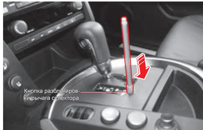
Для перевода рычага из положения «Р» необходимо включить зажигание и нажать педаль тормоза. Если при включенном зажигании и нажатой педали тормоза рычаг не выходит из положения «Р»:
