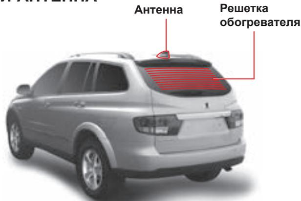
На стекло двери багажного отделения нанесена «решетка» (токоведущие дорожки) обогревателя заднего стекла. Будьте осторожны, чтобы не повредить дорожки при очистке внутренней поверхности стекла задней двери.
