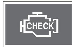
Если контрольная лампа «Проверь двигатель» мигает, необходимо увеличить скорость и в течение 15–20 минут двигаться со скоростью более 50 км/ч, этого времени достаточно, чтобы прошла регенерация CDPF. Когда количество сажи уменьшится до необходимого уровня, контрольная лампа «Проверь двигатель» погаснет.
