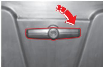
Откройте дверь багажного отделения и поверните рукоятку рычага по часовой стрелке. Затем толкните дверь.
