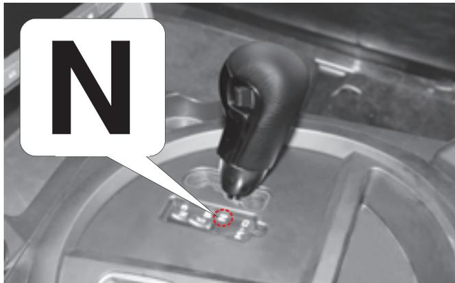
9 При этом положении рычага селектора передачи тягового усилия на колеса не происходит, и автомобиль не будет перемещаться при остановке на ровной горизонтальной площадке. Тем не менее, из соображений безопасности задействуйте тормозную систему, когда рычаг находится в этом положении.
