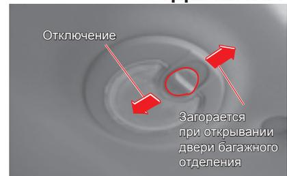
Если переместить данный переключатель по направлению к двери багажного отделения, светильник будет загораться при ее открывании. При перемещении переключателя в противоположном направлении светильник отключается и не будет загораться, даже если дверь багажного отделения будет открыта.
