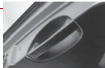
Для закрывания двери багажного отделения потяните за ручку и опустите дверь вниз. Затем надавите на дверь до ее полного закрывания.
