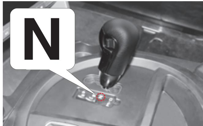
При этом положении рычага крутящий момент двигателя не передается на коробку передач.
